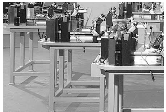
Mehrstellenmessvorrichtungen für eine Fertigungslinie im Zuliefererbereich der Luftfahrtindustrie Multi-position measuring apparatus for a production line in the supplier sector of the aviation industry
