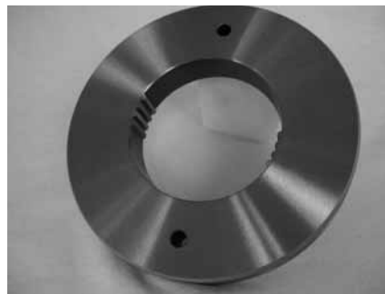
Ausschusslehring – Sektor verzahnt, DIN 5481 NoGo Spline Ring Gauge - Sector fully serrated teeth, DIN 5481
