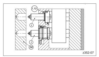
Picture 62: Konturplatte entfernen (HPS III-S Düse)
