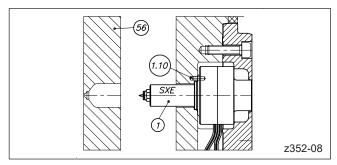
Picture 63: Konturplatte entfernen (HPS III-SXE Einzeldüse)
