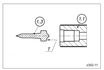
Picture 67: Düsenspitze montieren
