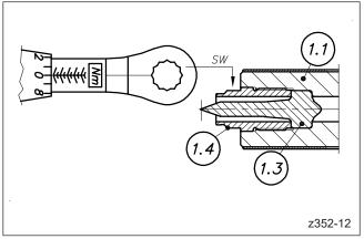
Picture 69: Düsenspitze mit Drehmoment anziehen
