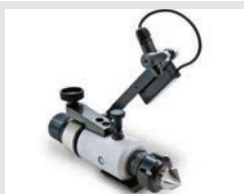
Nr art. 11280 Przysząd do ostrzenia pogłębiaczy i frezów SZVR do pogłębiaczy z chwytem walcowym dla średnic d=6-31 mm lub do MK3, a także do ostrzenia z czoła frezów 1-2-3-4-ostrzowych do d=20 mm. W komplecie z tulejka zaciskowa ER 32 d=10
