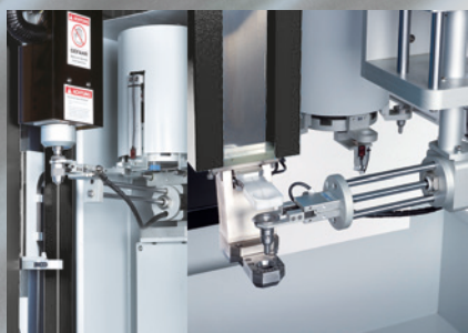
Zwischenführung und CNC-Elektrodenwechsler ATC (II.), CNC-Führungswechsler AGC (re.)
