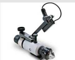
Nr art. 11280 Przysząd do ostrzenia pogłębiaczy i frezów SZVR do pogłębiaczy z chwytem walcowym dla średnic d=6-31 mm lub do MK3, a także do ostrzenia z czoła frezów 1-2-3-4-ostrzowych do d=20 mm. W komplecie z tuleją zaciskową ER 32 d=10
